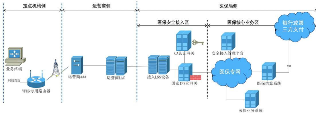
采用 4G VPDN 组网方式，所有无线终端设备都处于医疗保障局专用网络内，终端设备直接获取内网 IP 地址。各个关键设备要求如下：
