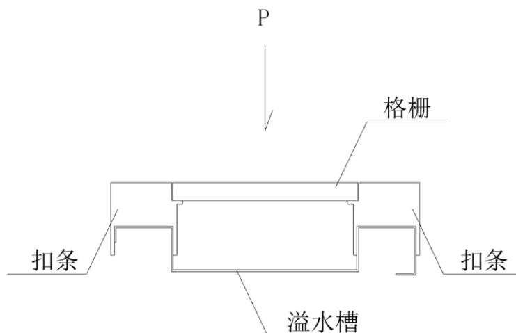
图 4 拆装式游泳池溢水槽承载能力测试示意图
