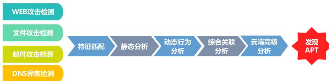
图 4 未知威胁预警平台检测流程
